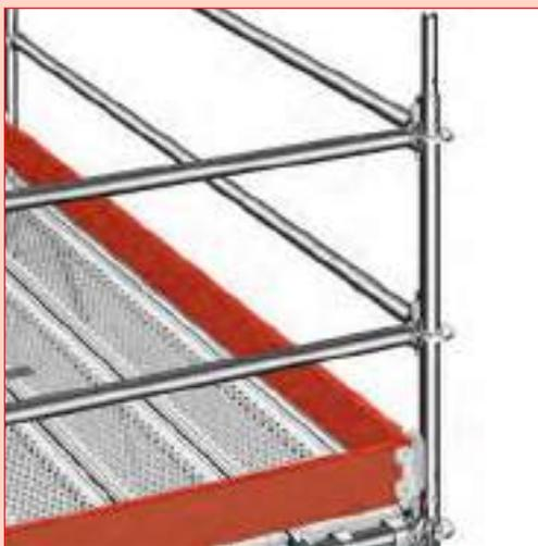
La protección triple lateral comprende el ▶ **Rodapié**, la ▶ **Horizontal** utilizada como barandilla intermedia, y la ▶ **Horizontal** utilizada como barandilla superior.
