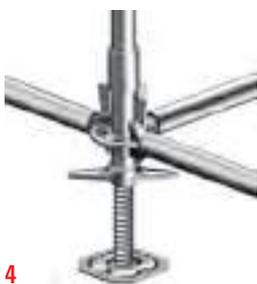
(4) Insertar los verticales para la formación del siguiente nivel. Estos se unen mediante el uso de horizontales estándar separadas en altura no más de 2 metros, horizontales en "U" o vigas, según la necesidad de colocar plataformas.
