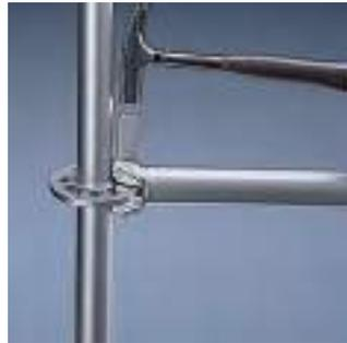
Un golpe con martillo en la cuña transforma la unión en una insuperable unión fija. La roseta sin cajeadado ni rebordes evita la posible obstrucción con hormigón, espuma, suciedad, etc. que podría dificultar el montaje.
