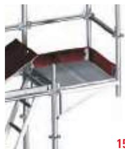
**(15)** Los voladizos con ménsula de 0,73 m. pueden ser reforzados con un tubo grapado **(15a)**. Para realizar voladizos sin usar ménsulas se puede jabolconar una horizontal en U con tubo y grapa **(15b)** o con diagonales **(15c)** o con tubos para plataformas T4 **(15d)**.
