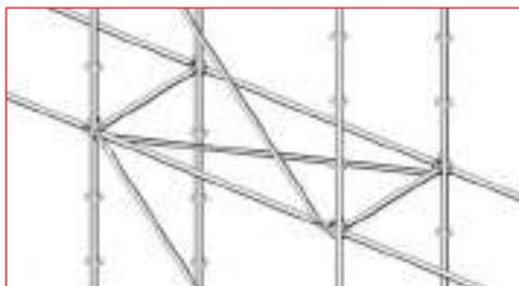
La ▶ **Diagonal en planta** con tetones, sirve para el replanteo de estructuras cúbicas complejas.
