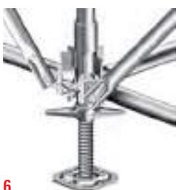
(6) Colocar diagonales para arriostrar los montantes verticales. En andamios estándar se ha de diagonalizar al menos uno de cada cinco módulos longitudinales. La disposición de las diagonales podrá realizarse continua o por torres. Se recomienda la diagonalización por torres (Fig. 6).
