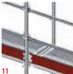
**(11)** Montar dos horizontales estándar para la formación de la barandilla de protección, quedando la superior a 1,0 m. de altura y la inferior a 0,5 m. sobre el nivel de plataforma.
