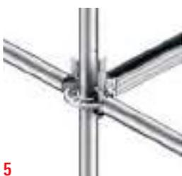
(5) Seleccionar la roseta del vertical precisa conforme a la altura necesaria de trabajo. La separación entre rosetas es de 0,5 metros, lo que permite variar la altura de plataforma según necesidad.
