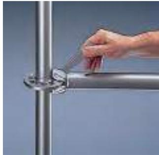
...e inmediatamente se asegura el nudo mediante el simple giro de la cuña. Esto significa que el montaje se puede realizar de forma segura por tan solo una sola persona, independientemente de la altura requerida.
