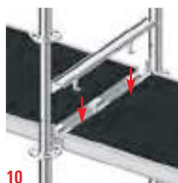
(10) Según las exigencias de carga de los trabajos a realizar podemos utilizar las plataformas Robust, realizadas en madera sobre bastidor de aluminio, con ancho de 61 cm. Para el acceso al nivel de trabajo se colocarán plataformas con trampilla y escalerilla.
